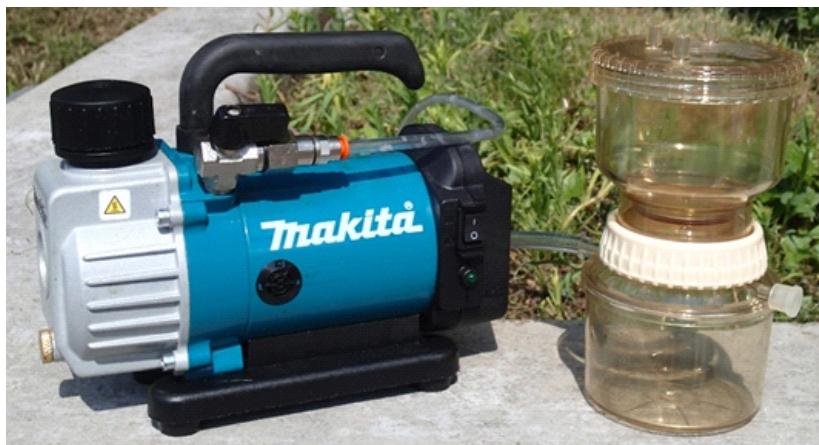
Obr. 6. Filtrační souprava s vývěvou
