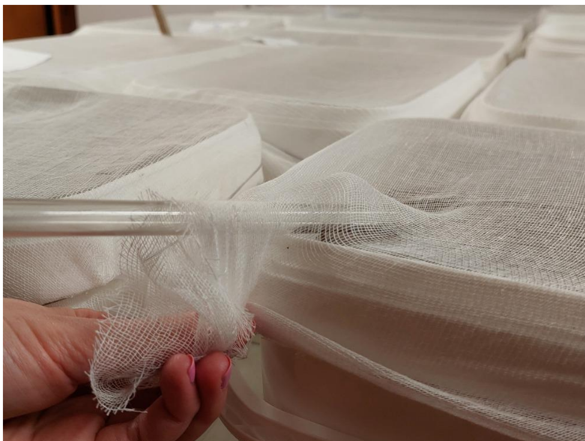
Obrázek 10: Ukázka utěsnění gázy při odsávání.
